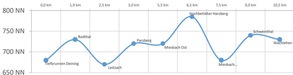
Von den Tiefbrunnen in Deining (Wörnsmühl) bis zum letzten Verbraucher in Wachlehen legt das Trinkwasser ca. 10,5 km in den Wasserleitungen zurück und überbrückt dabei Höhenunterschiede von über 100 Metern.
