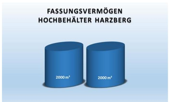
Die Tiefbrunnen in Deining sind 23 – 52 Meter tief und fördern mit Unterwasserpumpen in das Trinkwassernetz zum Hochbehälter am Harzberg. Der Hochbehälter besteht aus zwei Edelstahlkammern die jeweils 2.000 m³ Wasser fassen. Daraus ergibt sich ein gesamtes Fassungsvermögen von 4.000 m³ im Hochbehälter Harzberg, was einer Menge von 400.000 Getränkeboxen entspricht.
