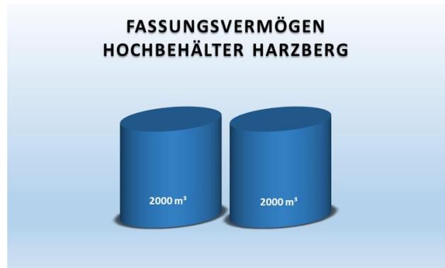
Die Tiefbrunnen in Deining sind 23 – 52 Meter tief und fördern mit Unterwasserpumpen in das Trinkwassernetz zum Hochbehälter am Harzberg. Der Hochbehälter besteht aus zwei Edelstahkkammern die jeweils 2.000m<sup>3</sup> Wasser fassen. Daraus ergibt sich ein gesamtes Fassungsvermögen von 4.000m<sup>3</sup> im Hochbehälter Harzberg, was einer Menge von 400.000 Getränkeboxen entspricht.
